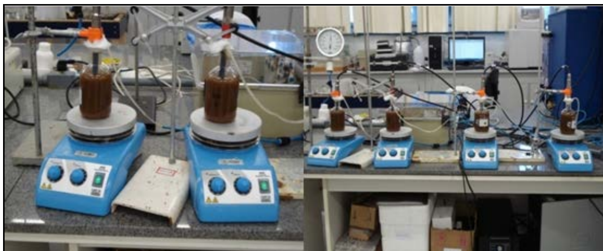
Figura 2: Respirômetro em garrafas de DBO, durante ensaio de OUR
