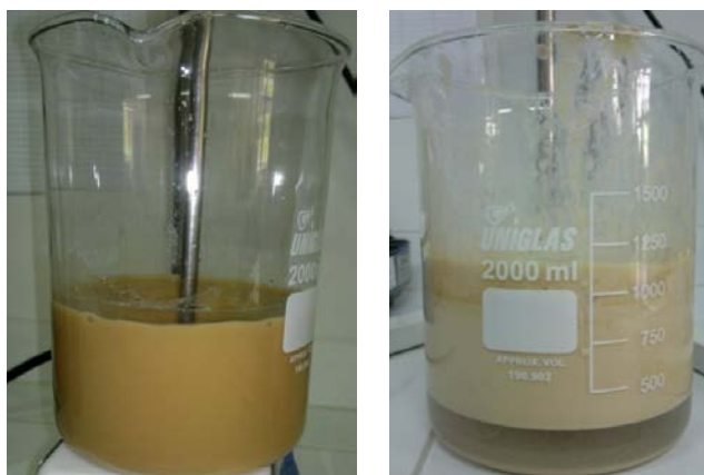
Figura 2: Comportamento da argila Bofe: (a) Hidrofílica e (b) Organofílica.
