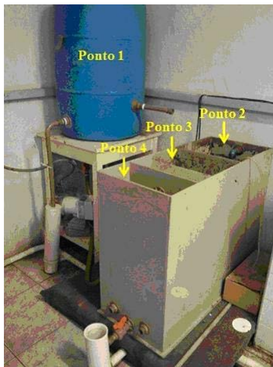
Figura 2 – Fotografia da montagem experimental e pontos de amostragem.
