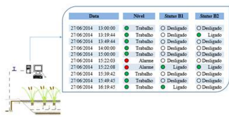
Figura 2: Controle on line pelo sistema SCADAweb® dos instantes de acionamento das bombas de alimentação do WCFV em ambos os sistemas.
