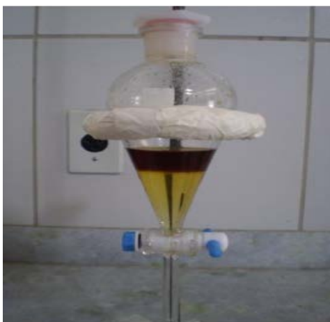
Figura 3 – Separação da fração aquosa do bio-óleo em diclorometano
