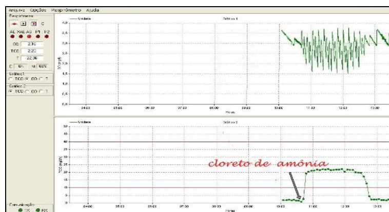
Figura 3: Respirograma da taxa de crescimento em função do substrato adicionado.
