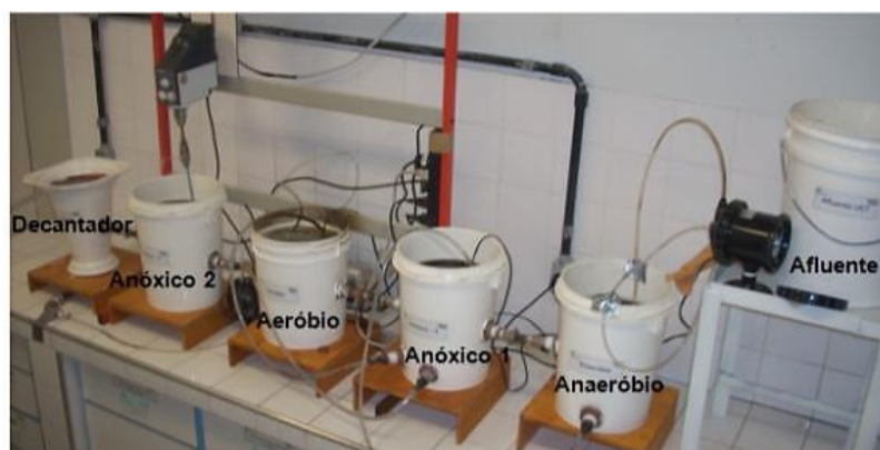
Figura 1: Configuração do Sistema UCT e da disposição dos reatores assim como dos seus elementos suporte (bombas dosadoras, recirculação, motor de agitação aerador).
