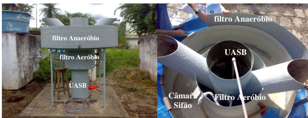
Figura 1: Sistema compacto de tratamento em escala unifamiliar monitorado para modelagem dos parâmetros (vista lateral e superior, em estágio de montagem)
