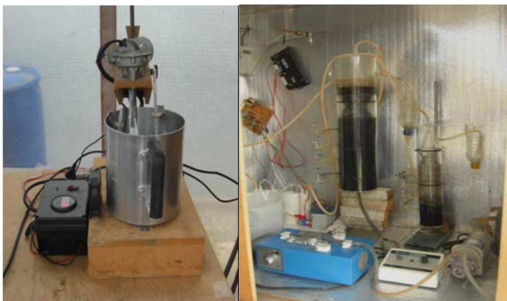
Figura 2 – Apresentação do sistema em operação: (a) Reator termohidrolisador (RT); (b) Reatores biológicos
