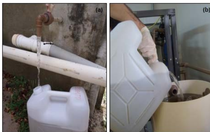
Figura 3: Coleta do efluente da ETE (a) e alimentação das membranas (b).
