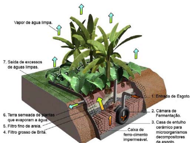
Figura 2: Ilustração de uma fossa séptica evapotranspiradora Fonte: Galbiati (2009).
