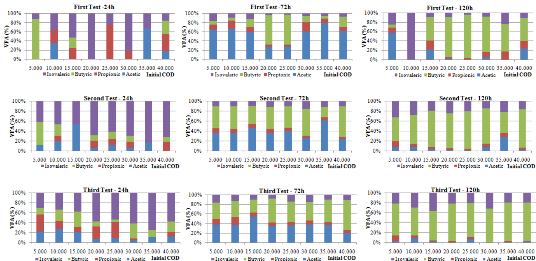
Figura 1: Composição dos ácidos graxos voláteis nos ensaios (a) primeiro teste, (b) segundo teste, (c) terceiro teste – 24h (1), 72h (2) e 120h (3) após o início do teste.
