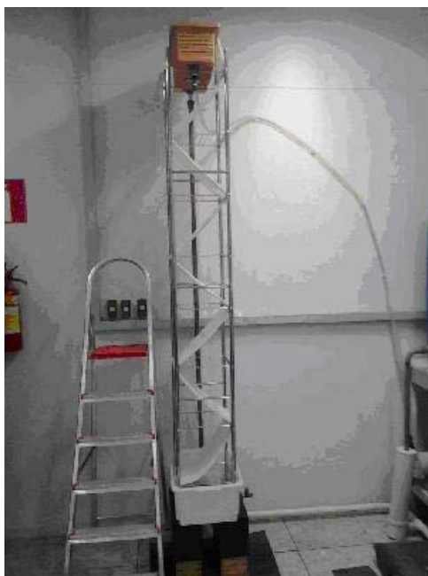
Figura 1: Reator modelo 1, alimentado por capilaridade.
