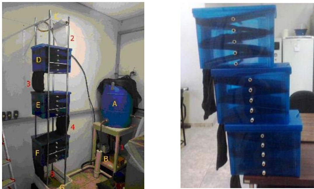
1- afluente bruto; 2 - efluente pré-filtro; 3 - efluente reator 1; 4 - efluente reator 2; 5 - efluente reator 3; A - tanque de equalização; B - bomba peristáltica – alimentação; C - pré-filtro; D - reator estágio 1; E - reator estágio 2; F - reator estágio 3; G - efluente tratado.
