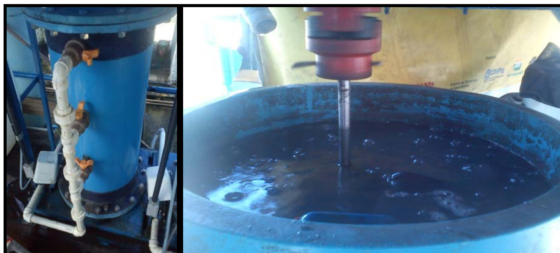
Figura 02. Reator de bateladas sequenciais em funcionamento.
