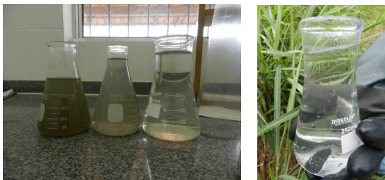
Afluentes ETE, efluente RAFA e efluente da capineira Efluente límpido da capineira
