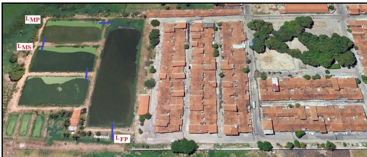
Figura 1: Vista superior do sistema de tratamento, da comunidade atendida e das lagoas consideradas no estudo sobre biodegradabilidade de efluentes.
