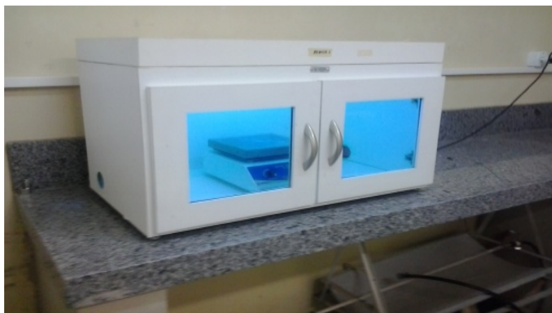
Figura 02: Câmara fotocatalítica de batelada.
