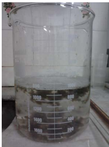
Figura 11: Processo de Coagulação e Floculação.
