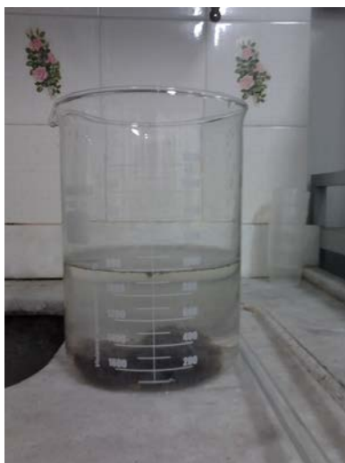
Figura 12: Sedimentação dos flocos.
