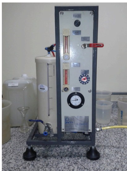
Figura 1. Equipamento de Microfiltração com Membranas Submersas.
