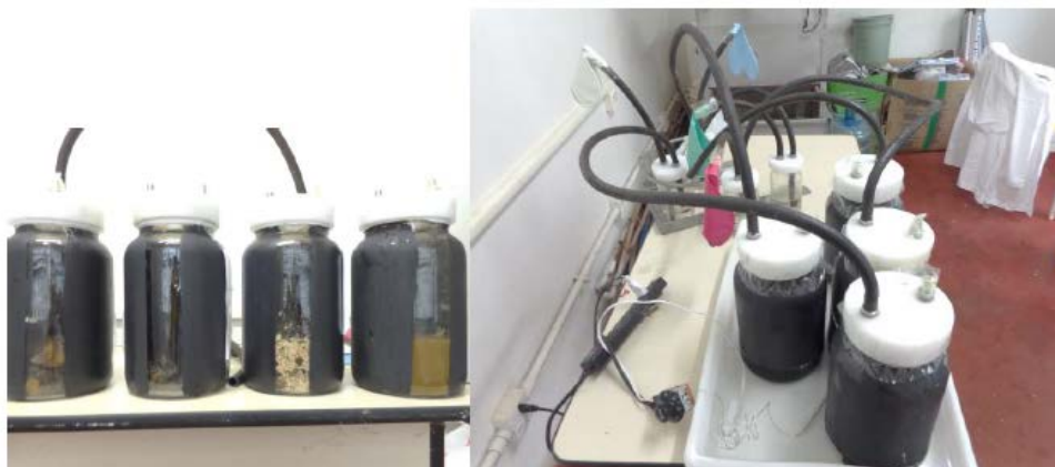
Figura 2: Módulo experimental dos biorreatores anaeróbicos desenvolvidos no estudo.
