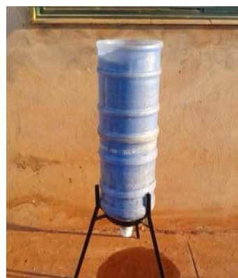
Figura 4. Montagem do filtro de areia para a realização do experimento.
