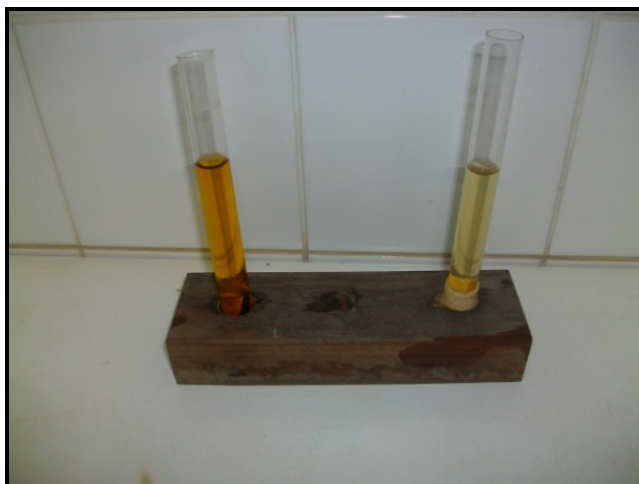
Figura 2. Ensaio colorimétrico do teor de impurezas orgânicas do agregado produzido com RCD. À esquerda, solução padrão de ácido tânico a 2%. À direita, solução de hidróxido de sódio a 3% em contato com os RCD.
