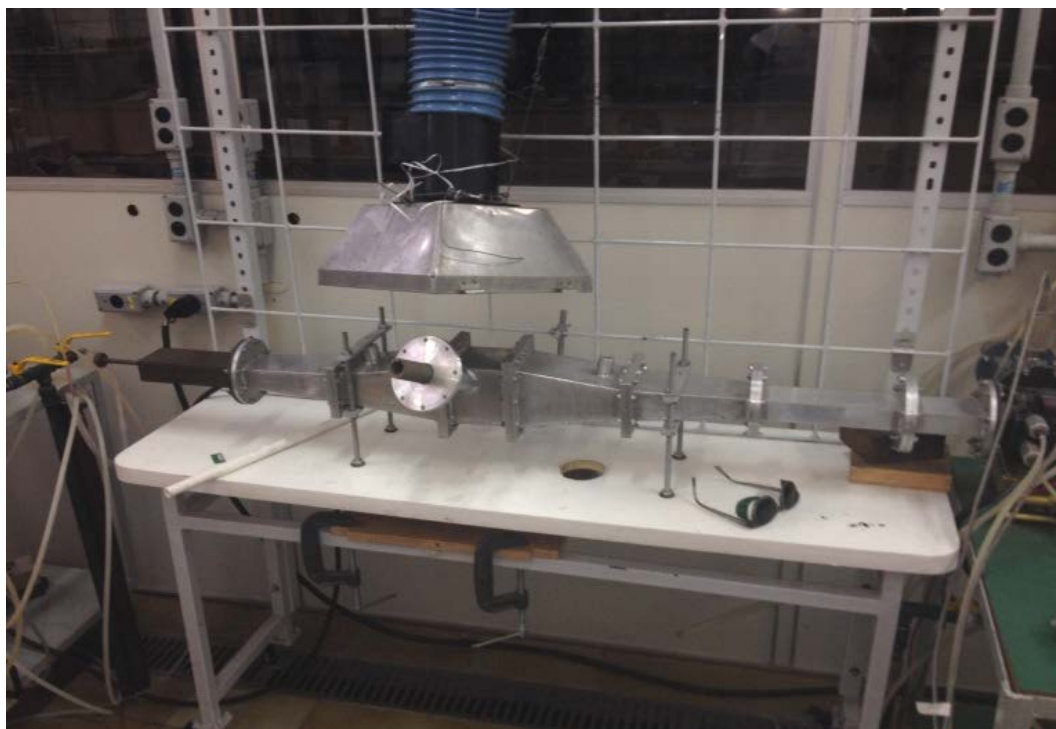
Figura 1 Equipamento de pirólise incentivada micro-ondas.
