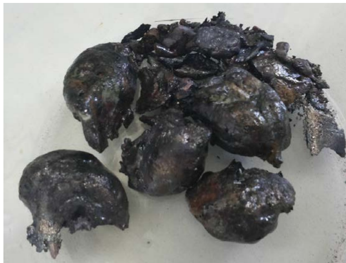
Figura 4: Placas de circuito impresso após pirólise.
