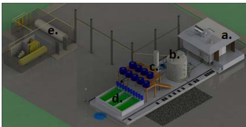
Figura 1: a) Contêiner de triagem/laboratório; b) reator de metanização; c) sistema de separação sólido-líquido e secagem do material digerido; d) sistema de pós-tratamento de efluentes líquidos; e) plataforma de tratamento e armazenamento de biogás
