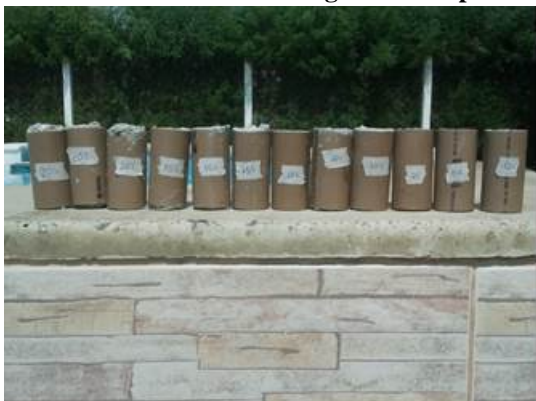
Figura 2: Corpos de prova ensaiados à compressão.
