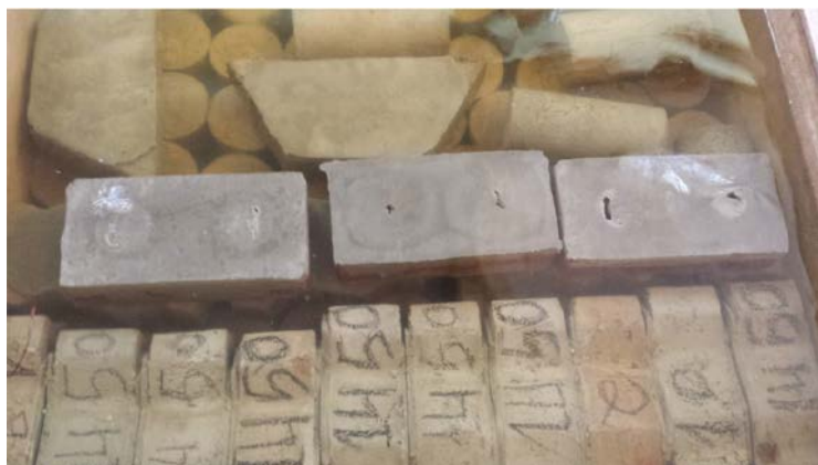
Figura 5: Corpos de prova imersos em água durante o ensaio de absorção.
