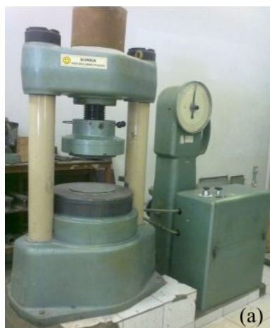
Figura 1: Prensa universal para ensaios de resistência à compressão (a) e Estufa para secagem utilizada na análise de absorção (b).
