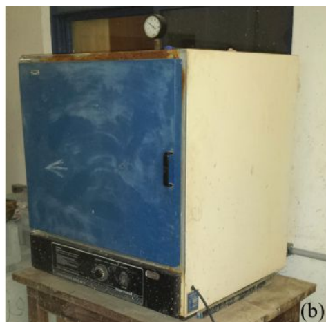
Figura 1: Prensa universal para ensaios de resistência à compressão (a) e Estufa para secagem utilizada na análise de absorção (b).
