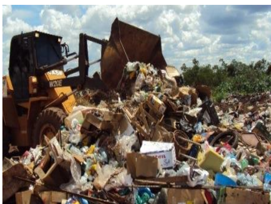
Figura 04 – Homogeneização dos resíduos – Figueirópolis D'Oeste
