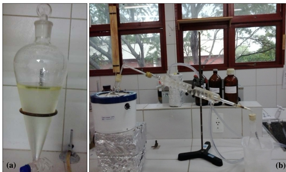
Figura 1 – Ilustração da análise de óleos e graxas: (a) extração de óleos e graxas da amostra utilizando funil de separação e (b) destilação do extrato lixiviado.
