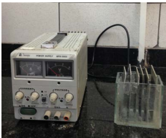
Figura 1 - Reator de vidro com placas de alumínio e fonte alimentadora
