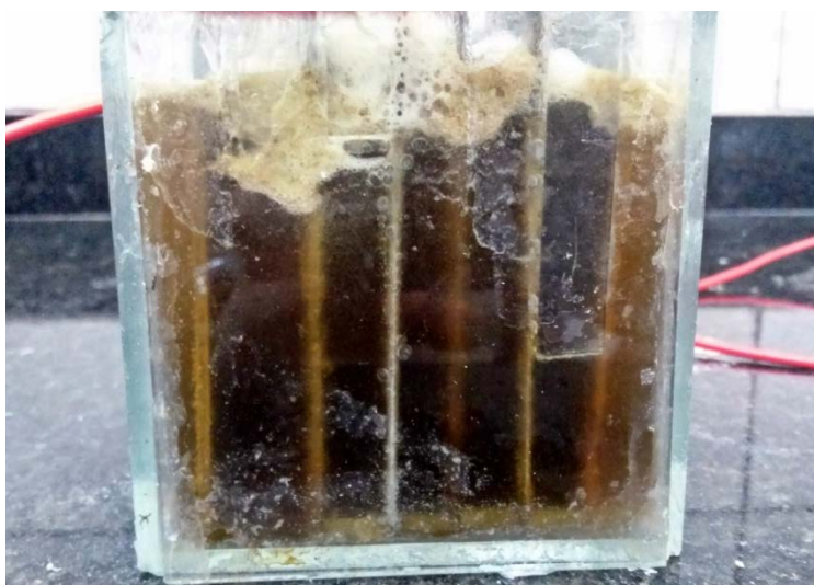
Figura 8 - Tratamento eletrolítico sendo aplicado na amostra.
