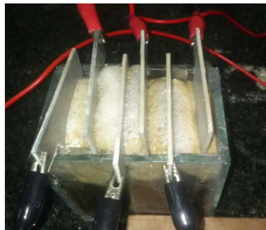
Figura 2 - Reator com placas de alumínio e posição dos ganchos em operação.
