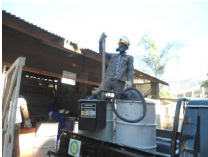
Figura 2 – Sistema bulb eater em operação. Fonte: Maracanã, 2011.
