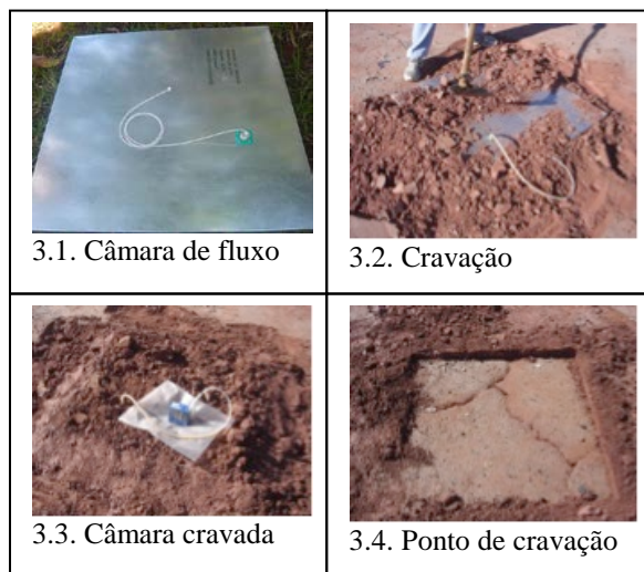
Figura 3: Etapas de cravação das câmaras de fluxo.
