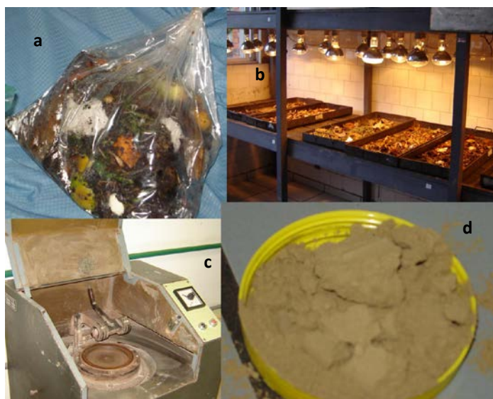
Figura 1 – Preparação das amostras: (a) amostra bruta; (b) secagem, (c) equipamento de moagem, (d) amostra pronta para as análises e determinações
