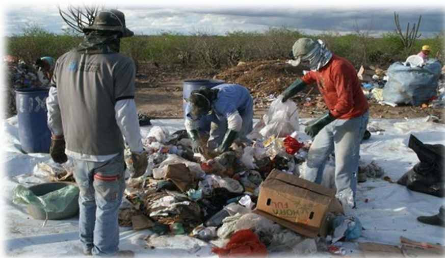
Figura 2: Rompimento dos sacos para homogeneização da amostra. Soledade-PB em 23/04/2013 e 23/05/2013.
