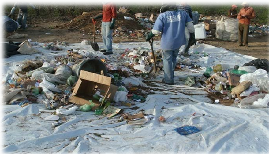
Figura 3: Processo de quarteamento. Soledade-PB em 23/04/2013 e 23/05/2013.
