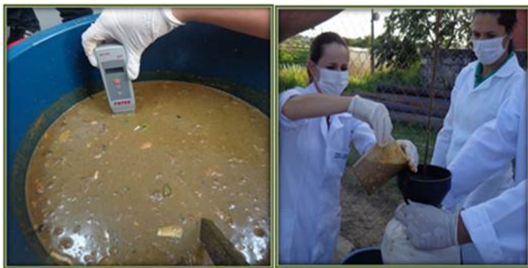
Figura 2: (A) Mistura dos resíduos (matéria orgânica + esterco + água) e (D) enchimento dos biorreatores.
