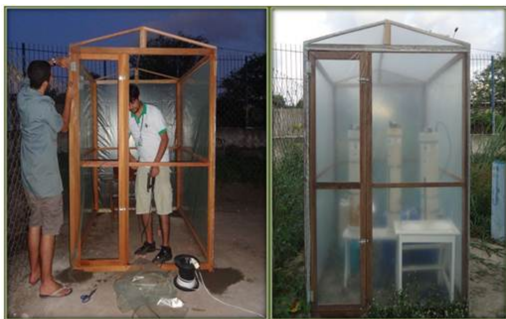
Figura 3: Estufa para aumento da temperatura interna do biorreator.
