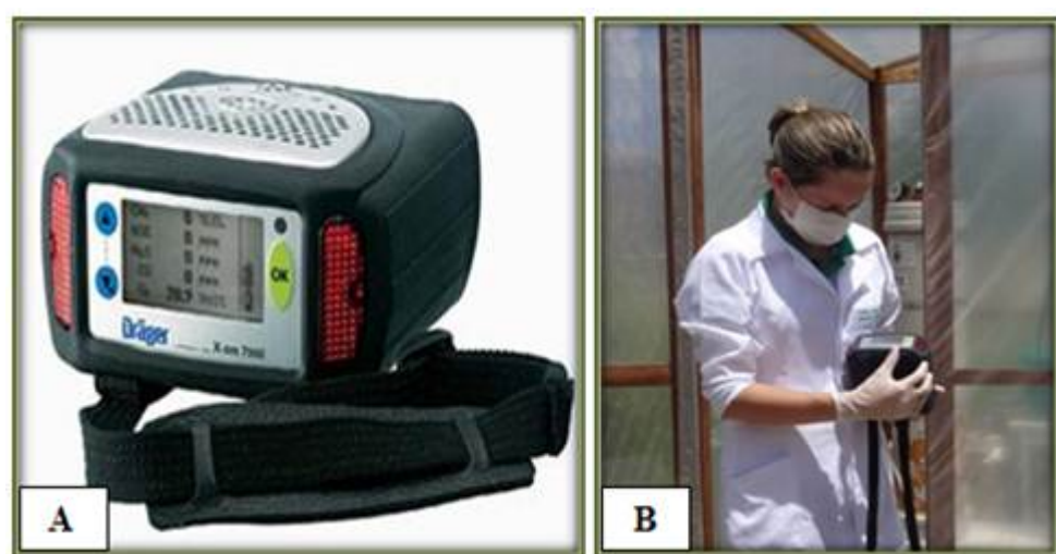
Figura 5: Leitura das concentrações dos gases através do equipamento Drager.
