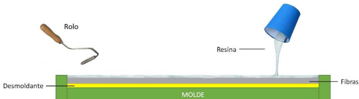
Figura 1 – Processo de laminação manual
