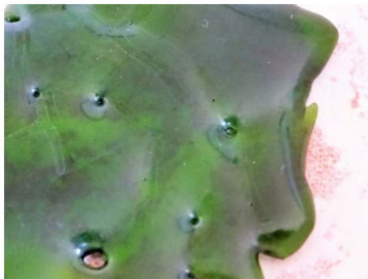
Figura 8 - Resultado do vidro triturado após o terceiro ciclo de fusão.
