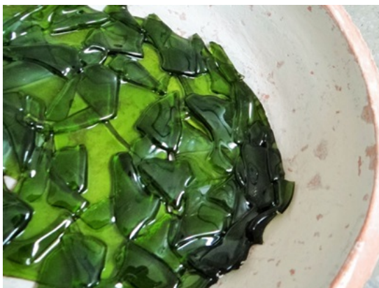
Figura 6 - Resultado do vidro triturado após o terceiro ciclo de fusão.
