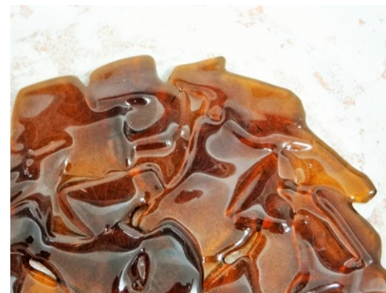
Figura 7 - Resultado do vidro triturado após o quarto ciclo de fusão.
