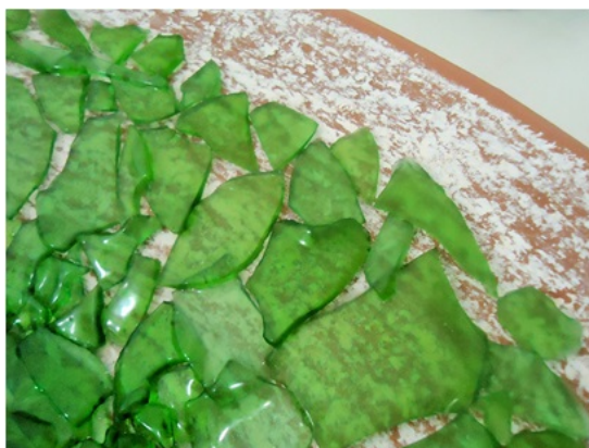
Figura 4 - Resultado do vidro triturado após o primeiro ciclo de fusão.
