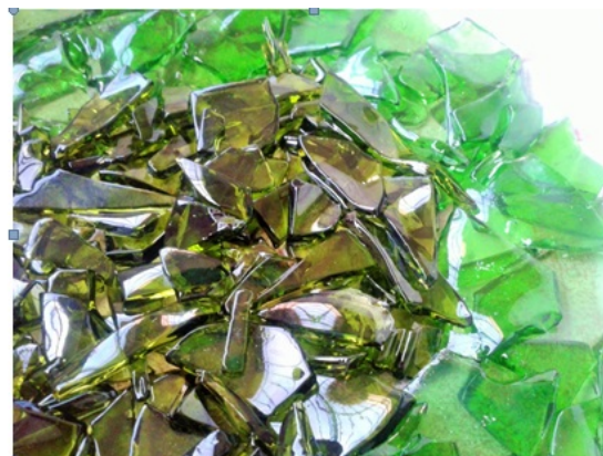
Figura 5 - Resultado do vidro triturado após o segundo ciclo de fusão.
