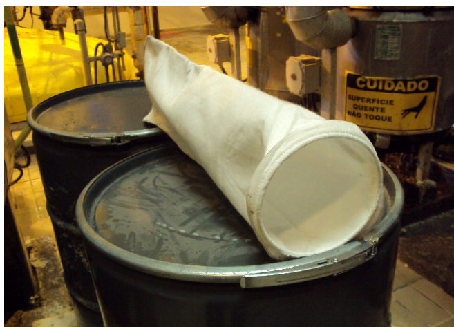
Figura 2: Manta em tecido para filtragem de óleos vegetais
