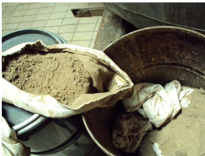
Figura 3: Manta de filtragem com torta (argila ativada e perlmax)
