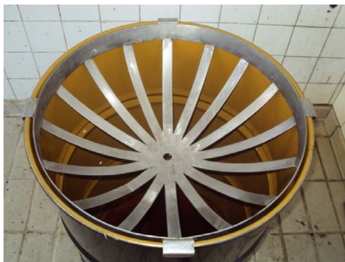
Figura 6: Peneira para separação de resíduos instalada no recipiente de armazenamento.
