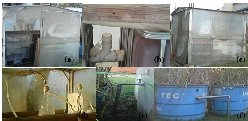
Figura 1: Sistema de biodigestores e zona de raízes utilizados neste trabalho; (a) sistema de biodigestores montados em 2 contêineres plásticos; (b) tubulação de 50 mm que comunicava o primeiro com o segundo contêiner; (c) biodigestores enclausurados em uma estrutura de policarbonato; (d) sistema de lavador de gases; (e) tubulação que comunicava os biodigestores ao sistema de zona de raízes; (f) sistema de zona de raízes.
