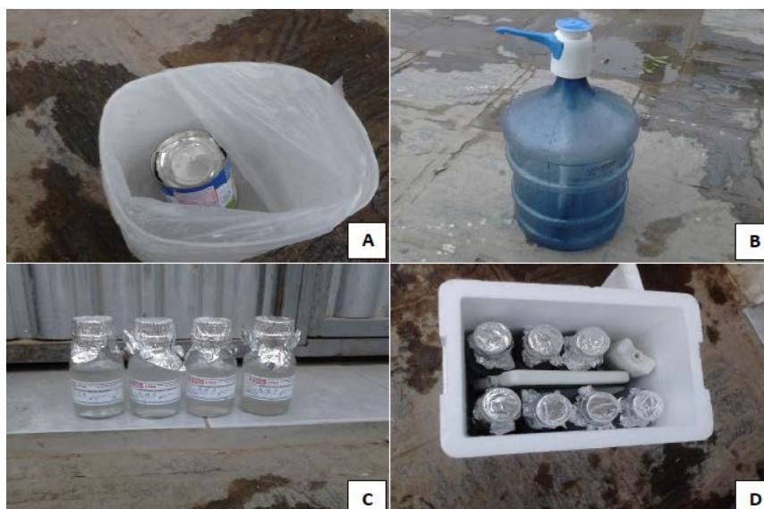
Figura 2. Organização de amostras para análises microrgânicas a partir dos resíduos sólidos urbanos. Lavagem dos resíduos em recipiente e saco estéril – A; Garrafão com bomba contendo água bidestilada e deionizada – B; Amostras engarrafadas e devidamente identificadas – C; Acondicionamento das amostras para encaminhamento à análise – D. Fonte: Batista (2014).
