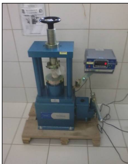
Figura 8 – Equipamento utilizado no ensaio de resistência à compressão.
