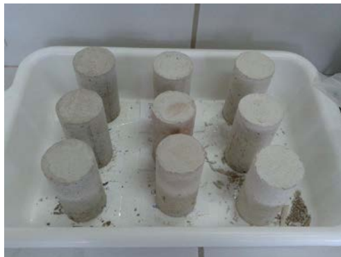
Figura 7: Corpos de Prova desmoldados
