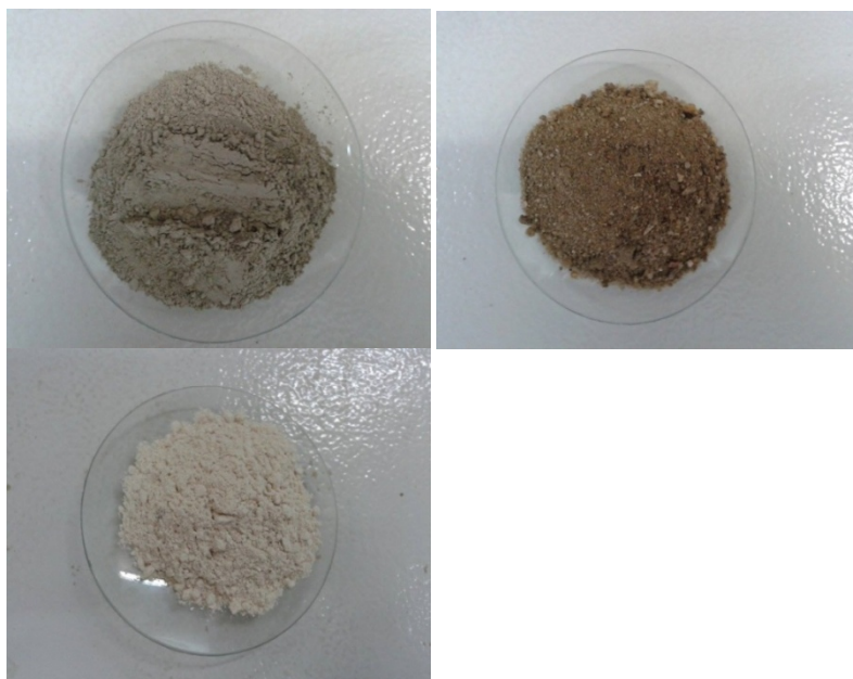
Figura 6 – Materiais utilizados na preparação dos corpos de prova com incorporação de caulim.
