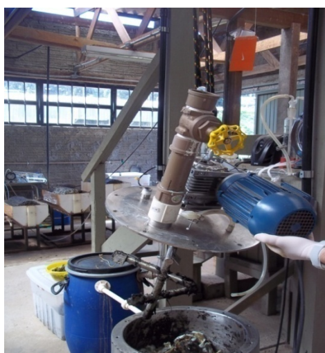
Figura 3: Abertura do sistema para retirada do material digerido em excesso.
