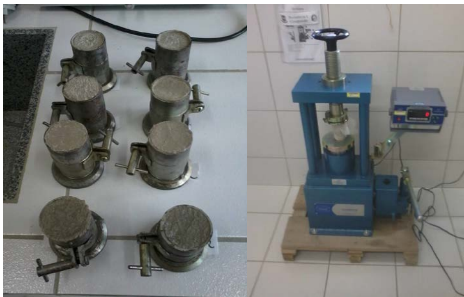
Figura 2 – (a) Corpos de prova para o ensaio de resistência à compressão. (b) Equipamento utilizado no ensaio.
