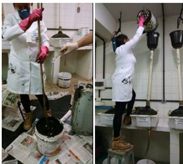
Figura 2 – adição do coagulante no lodo e alimentação dos bags da montagem experimental utilizado no estudo.
