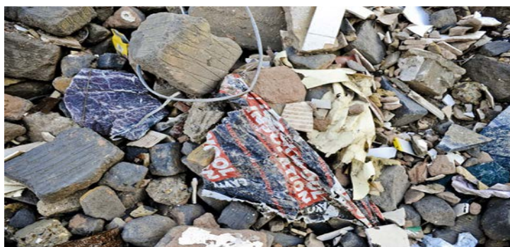
Figura 1: Resíduos de construção e demolição contaminados (HONÓRIO, 2010)
