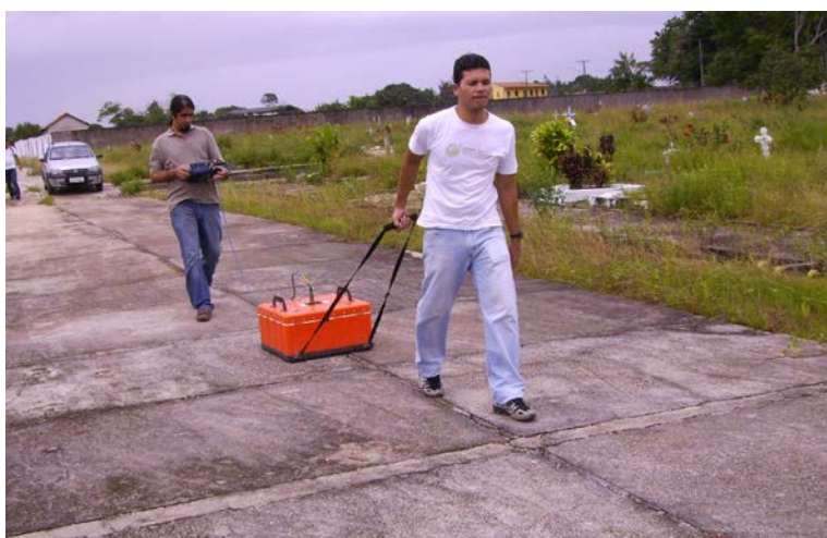
Figura 3: Aquisição de dado geofísico com GPR no cemitério do Tapanã, Belém Pará.
