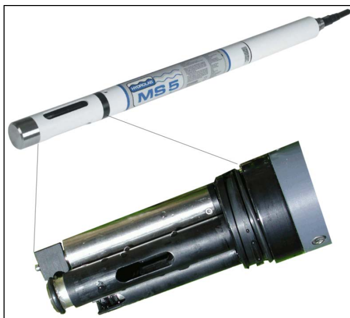
Figura 2: Sonda de Qualidade da Água Hydrolab MS-5, com destaque nos sensores
