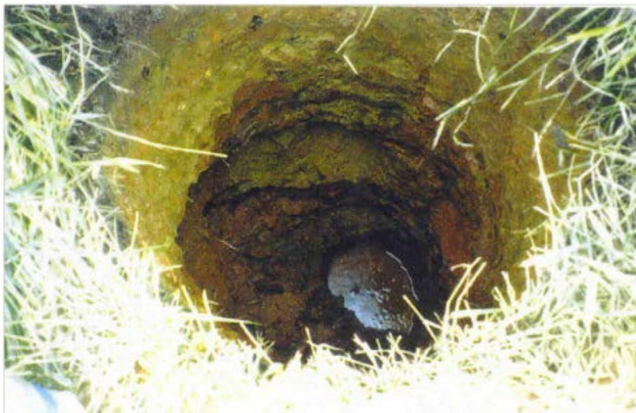
Figura 4 – Início da elevação do nível d’água no poço número 1, podendo-se notar a saída de bolhas de ar aparentando processo de “ebulição”
