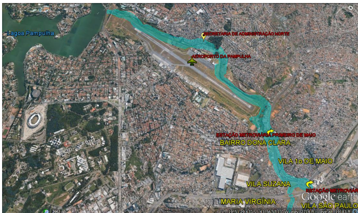
Figura 6 – Mancha de Inundação Proveniente do Rompimento Hipotético da Barragem da Pampulha
