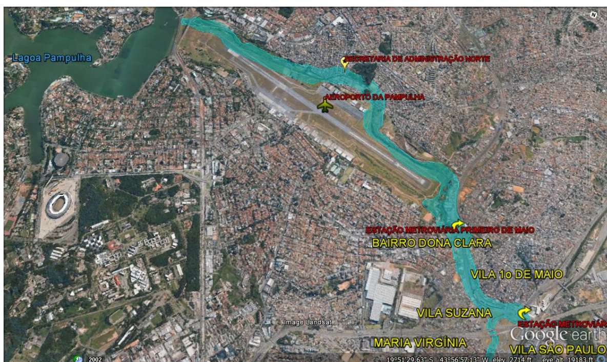
Figura 2 – Mancha de Inundação Devido ao Rompimento Hipotético da Barragem da Pampulha Fonte: Braz e Pereira (2015)
