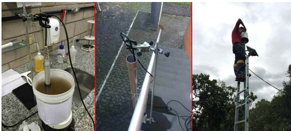
Figura 2: Fenômenos hidrológicos controladamente simulados para a aferição e calibração dos sensores. À esquerda sedimentos em suspensão. No centro, diferentes colunas hidrostáticas em um cano de PVC. À direita, testes de sensibilidade do pluviômetro sendo realizados in loco .
