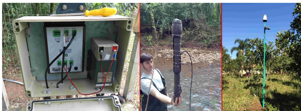
Figura 3: À esquerda, o datalogger alocado junto à bateria suplementar dentro da caixa hermética. No centro, a cápsula protetora dos sensores de nível e sedimentos antes da instalação no leito do arroio. À direita, o poste com o painel fotovoltaico e pluviômetro devidamente montados no campo.
