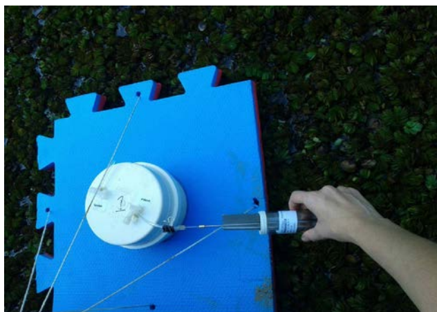
Figura 4. Coleta de amostra na Câmara de gás na área alagada em um banco de macrófitas aquáticas.
