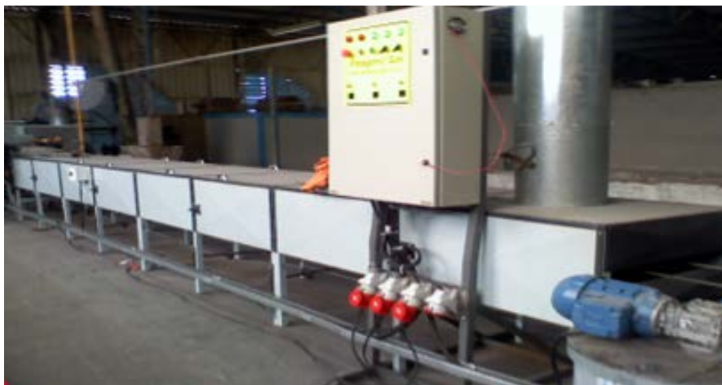
Figura 5: Nova estufa de secagem com maior capacidade
